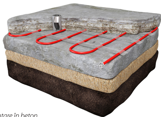
Montare în beton
