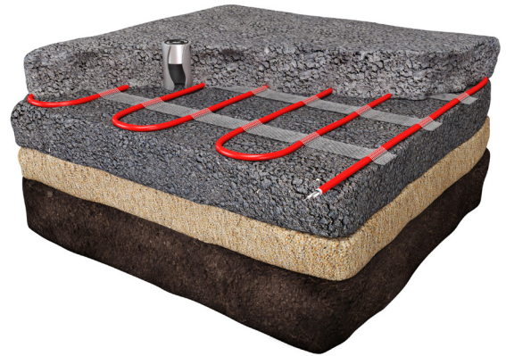
Montare în asfalt derulat
